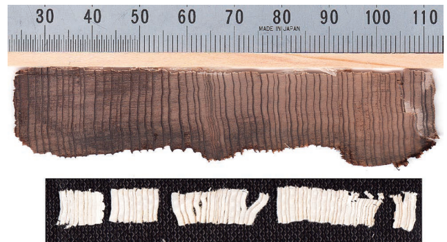
セルロース抽出前(上)と抽出後(下)の薄板。スケールは同じ
