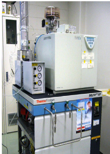
安定同位体比測定のための質量分析装置 (地球研地下実験室)
