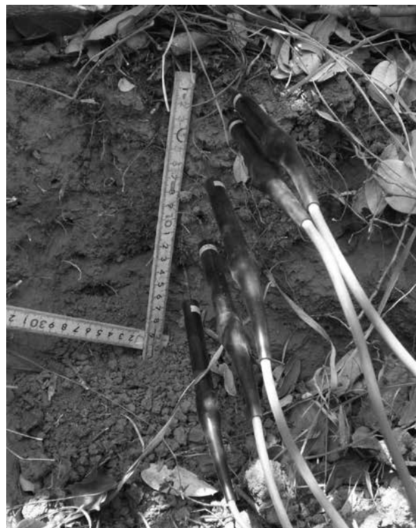
図 3-4 火入れ中の温度変化の測定 （2010 年 10 月撮影）
