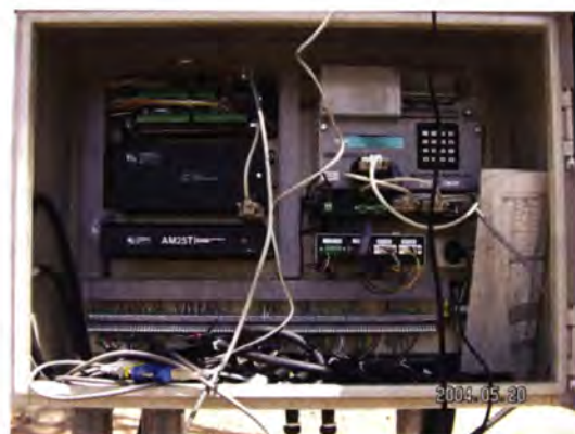
図 1 (左) 長武試験地に設置した分光放射計 (MS-700), (右) FROS データ収録システムのうち、分光放射データ処理を行う Campbell Sci. Inc. 社製 CR-21X (右) およびシリアル入力切り替え器 (CR-23X の下に設置)。
