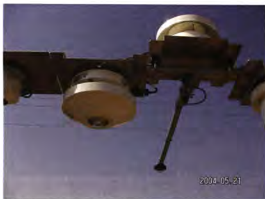
図 1 (左) 長武試験地に設置した分光放射計 (MS-700), (右) FROS データ収録システムのうち、分光放射データ処理を行う Campbell Sci. Inc. 社製 CR-21X (右) およびシリアル入力切り替え器 (CR-23X の下に設置)。
