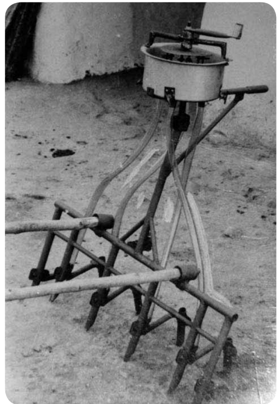
写真4 4条用の播種兼施肥器 カルナータカ州の篤農家による改良品
