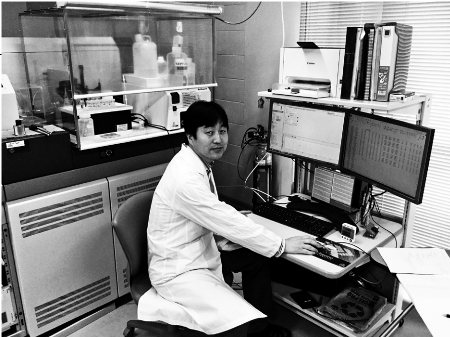
研究につかった安定同位体比分析装置マルチコレクター ICP-MSで測定する申さん
