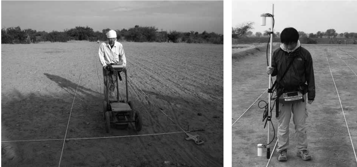
図 11 GPR 探査風景（左）とセシウム磁力計による磁気探査風景（右）
