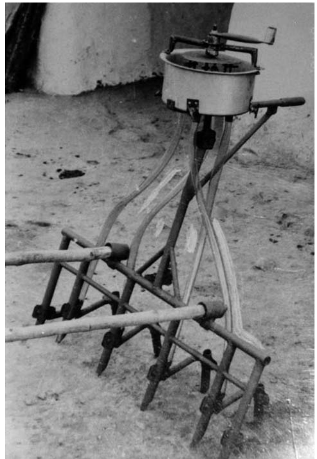
写真4 4条用の播種兼施肥器 カルナタカ州の篤農家による改良品
