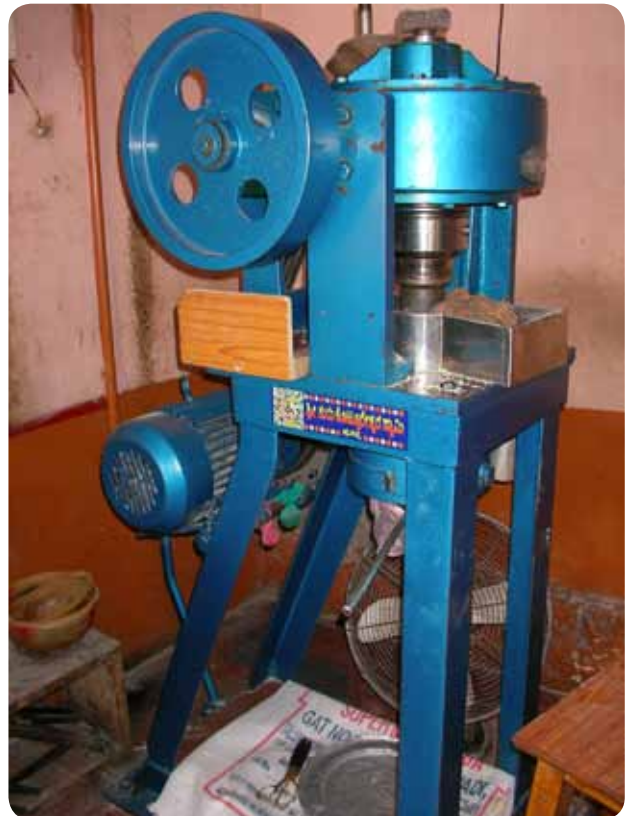
写真2 加圧押し出し式のシャーヴィゲ製造機、バツラーリ県H.B.ハリ (10年)
