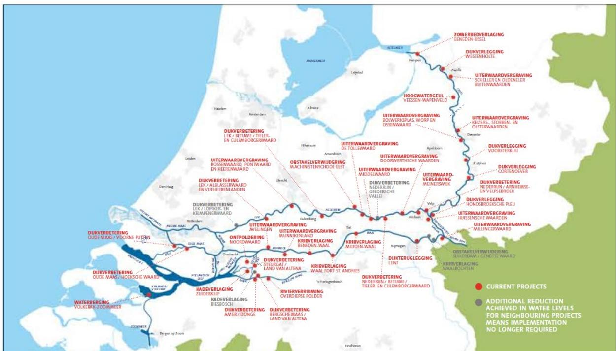
図4. 「川のための空間」プログラムの対策図と対応する対策プログラム。選定された39地域のうち4地域の対策は、近隣地域で水位の低下が達成されたため不要と判断された。Dutch Ministry of Water Management, Transport and Public Works (2012) より引用。
