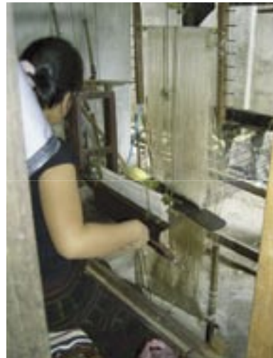
写真-6：織機。織り手の手前から箴、綜紙、垂直紋綜紙が吊り下げられている。
