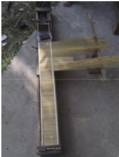
写真-5：箴編み作業の途中。右上部がはみ出た部分。横型タイプの箴編み台
