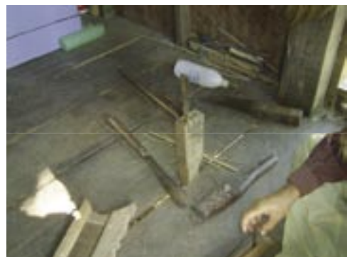
写真-16：幅を揃える台（床の隙間を利用して固定）
