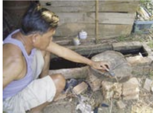
写真-14 : カン・タオを削る。脇にある水のためにカン・タオをつけておく
