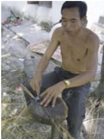
写真-3：薄く削いだ竹を、厚み、幅を揃えるために削っていく
