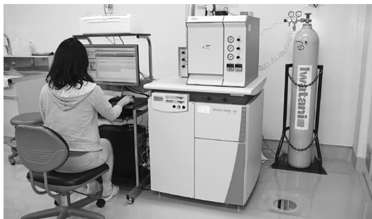
木材年輪の酸素同位体比を測定するための分析装置
