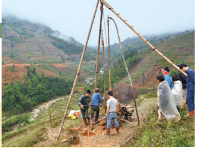
ベトナム・ラオカイにおける地すべり調査のようす。地下水位 モニタリングセンサー設置のためのボーリング作業
