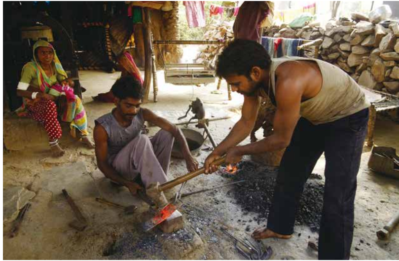
写真⑨熱された鉄を叩いて成形する
