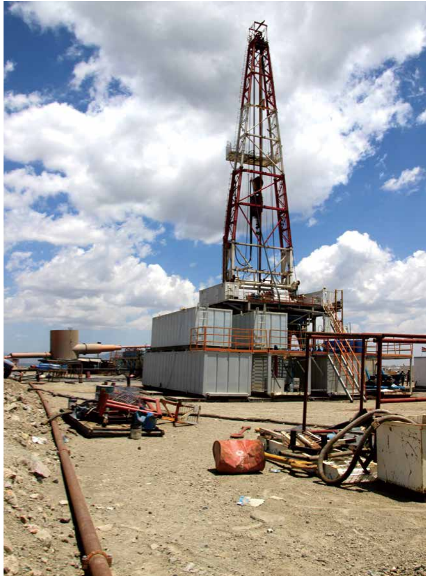
写真②深さ 2000 m の井戸を掘り熱源を得る
