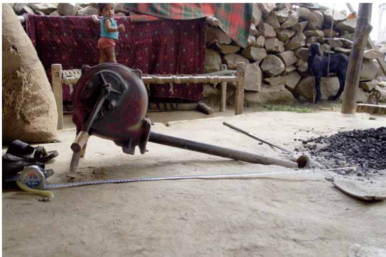
写真⑤フィゴ(工場制手回し式)
