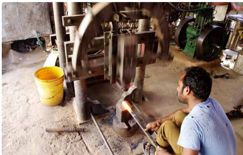
写真⑧エンジン付自動槌による成形
