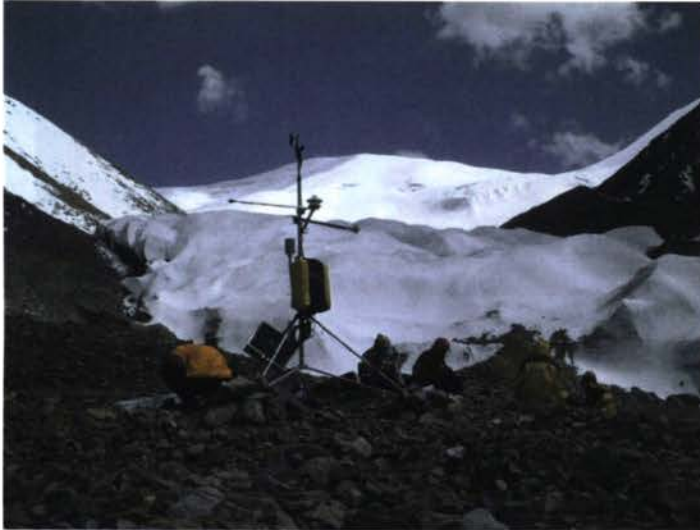
図3 氷河末端に設置した自動気象計 (AWS)
